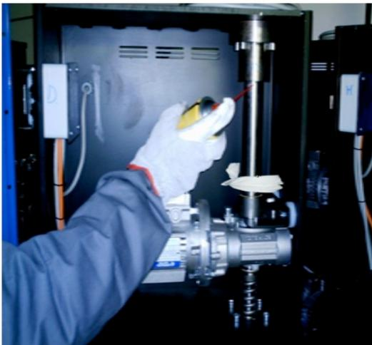
Allumer la console et pendant qu'on fait monter la plaque vaporiser le dégrissant sur le piston de manière qu'il est emmené à l'intérieur de la boucle de conduite du piston
