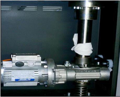
Lier à la base du piston de la plaque un chiffon pour empêcher que le liquide du spray s'infilte dans le moteur.
